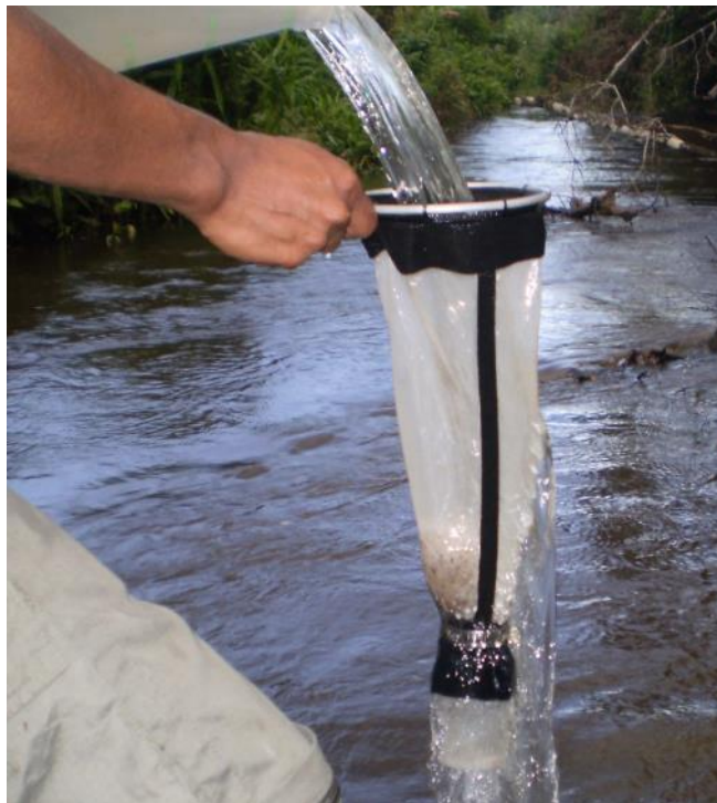
Figure 1. Detalle de la malla del filtrado junto con el recipiente de 200 ml.
