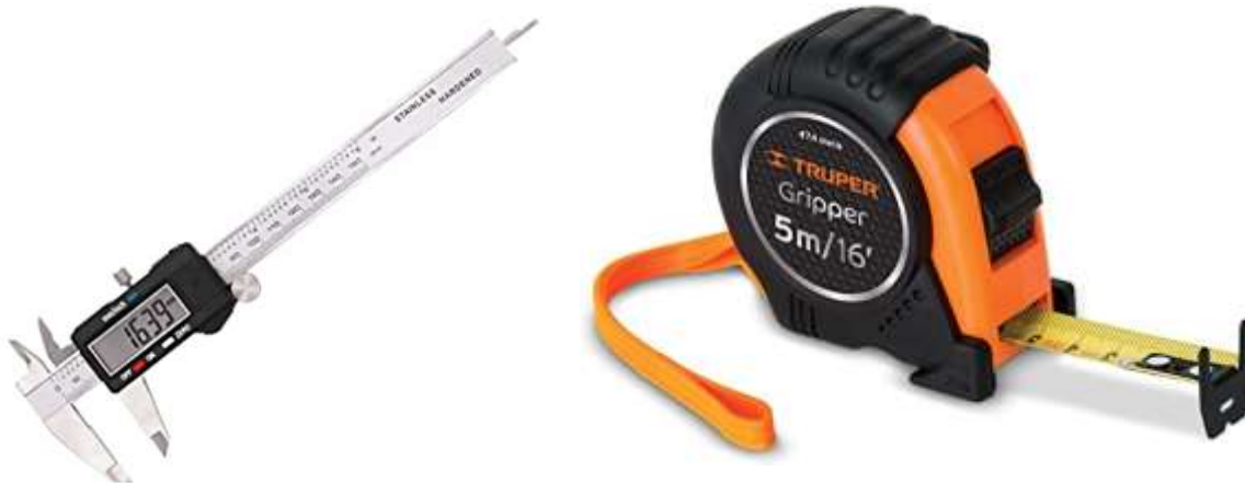
Figure 5. Equipos utilizados para la medición de plantones. Izq: Vernier digital. Der: Cinta métrica.
